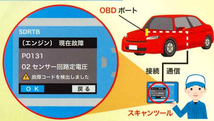
「スキャンツール」をOBDポートに接続し、「OBD」が記録している、各種装置の故障の有無や作動状況（故障コード）を読み出します。これにより、装置が正常に作動しているかを確認することを、「OBD点検」と呼んでいます。
